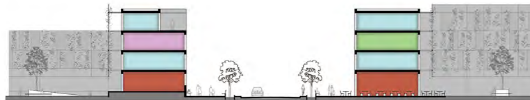
Coupe de profil de l'axe Terroux - Edouard-Sarasin représentant le projet d'élargissement du chemin par l'implantation d'une piste cyclable, d'un front végétal, et d'espaces publics (trottoir, et parvis en rez-de-chaussée) de part et d'autre de la chaussée. Ce projet propose d'élargir ainsi l'axe de 9m à 26m.
